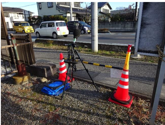
道路交通騒音調査(所沢狭山線)
