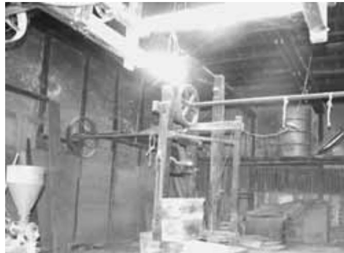
22. 2列 12 個の搗き杵が稼動していた跡に改造型の搗臼が 1 個、壁の向こう側物置にも動力を伝えて丸鋸製材を行っていた
