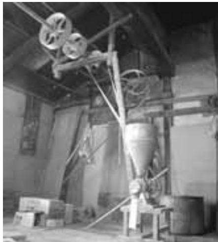
21. 水車搗き場の痕跡を残す、今は電動機による精米機が稼動する
