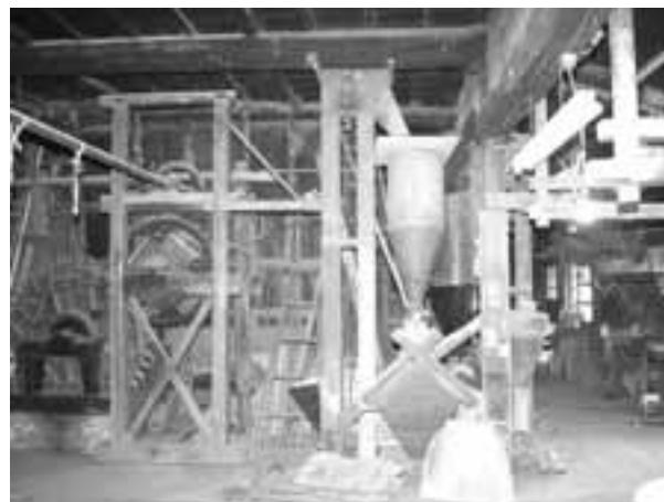
28. 新旧の機械が混在し、正面は現役の電動ベルト式精米機
