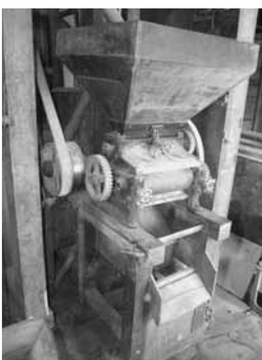
48. 押し麦機、製粉の下処理工程に使用
