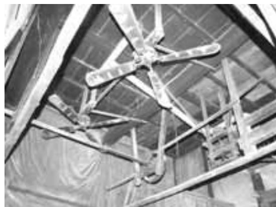
57. 乾麺を干す乾燥場、木製羽扇風機もブーリーと平ベルトで回転する
