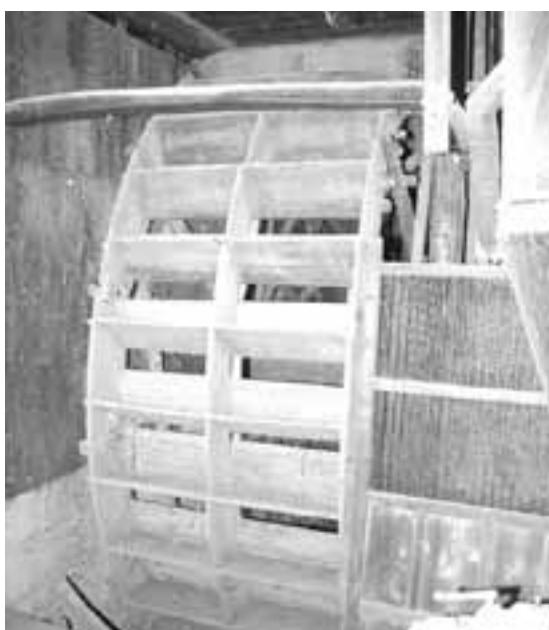
58. 水輪の直径 4.84 m 幅 1.35 m、上流側から見て上から下に向かって回転する
