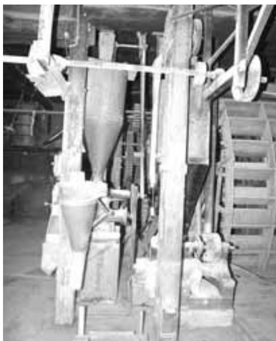
40.41. 昭和 12 年 1 月に導入した精米機は水車動力だった。のちにディーゼル発動機、現在稼動する精米機は電動モーターへと変わっている
