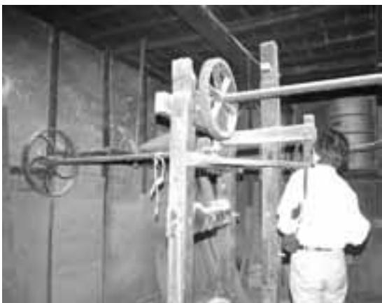
25. 壁裏で製材する丸鋸に動力を伝えたという軸
