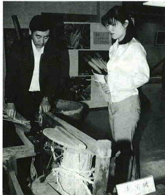
これが藁で縄をなう機械でね、こんなふう に藁を通すと・・・縄ができるんだよ。と大野所長
