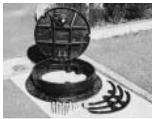
写真の右下にあるのがスパーサー。5mmずつマンホールの高さを調節できます。
