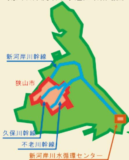
狭山市の公共下水道を流れている汚水は、県が管理する3つの「流域下水道」を経由して新河岸川水循環センターで処理されています
