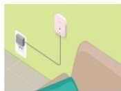
壁面設置（両面テープ使用）
